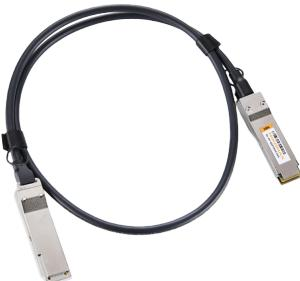
Адаптер соединительный (Direct Attach Copper Cable) - представляют собой твинаксиальный кабель с жестко закрепленными трансиверами на обоих концах. Обычно для оконечивания кабеля используются форм-факторы трансиверов SFP+, SFP28, QSFP+, QSFP28, QSFP56. Являются удобной альтернативой оптическим трансиверам на небольших расстояниях.
