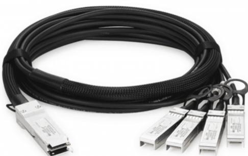
Пассивная кабельная сборка NIKOMAX GL-CC-QSFP4SS-010 - это медные кабели прямого подключения 100G QSFP28 подходят для работы на очень коротких расстояниях (1 метр) и предлагают высокоеэкономичный способ организации связи между портом QSFP28 на скорости 100 Гбит/с коммутатора и 4-мя портами SFP28 на скорости 25 Гбит/с в других коммутаторах.
