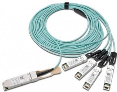
Активная кабельная сборка NIKOMAX GL-CC-QSFP4SS-030-AOC - это оптические кабели прямого подключения 100G QSFP28 подходят для работы больших расстояниях чем медные дас-сборки и предлагают высокоэкономичный способ организации связи и меньшие задержки между портом QSFP28 на скорости 100 Гбит/с коммутатора и 4-мя портами SFP28 на скорости 25 Гбит/с в других коммутаторах.
