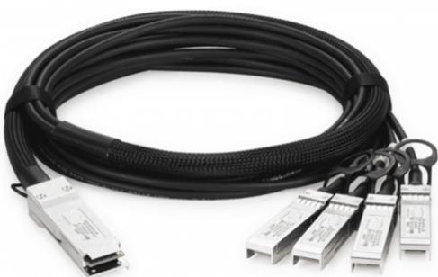
Пассивная кабельная сборка NIKOMAX GL-CC-QSFP4SS-030 - это медные кабели прямого подключения 100G QSFP28 подходят для работы на очень коротких расстояниях (3 метра) и предлагают высокоеэкономичный способ организации связи между портом QSFP28 на скорости 100 Гбит/с коммутатора и 4-мя портами SFP28 на скорости 25 Гбит/с в других коммутаторах.
