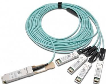
Активная кабельная сборка NIKOMAX GL-CC-QSFP4SS-070-AOC - это оптические кабели прямого подключения 100G QSFP28 подходят для работы больших расстояниях чем медные dac-сборки и предлагаю высокоеэкономичный способ организации связи и меньшие задержки между портом QSFP28 на скорости 100 Гбит/с коммутатора и 4-мя портами SFP28 на скорости 25 Гбит/с в других коммутаторах.
