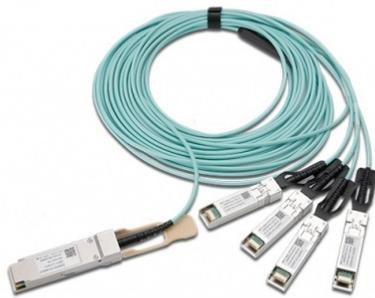
Активная кабельная сборка NIKOMAX GL-CC-QSFP4SS-070-AOC - это оптические кабели прямого подключения 100G QSFP28 подходят для работы больших расстояниях чем медные дас-сборки и предлагают высокоэкономичный способ организации связи и меньшие задержки между портом QSFP28 на скорости 100 Гбит/с коммутатора и 4-мя портами SFP28 на скорости 25 Гбит/с в других коммутаторах.
