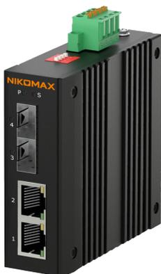
Медиаконвертер PoE промышл. неуправляемый NIKOMAX, UTP 2\*10/100/1000 Мбит/с (802.3af/at) до 250 метров, 2\*SFP 100/1000 Мбит/с, без LFP, PoE watchdog, Port isolation, 44-57В (без блока питания), -40 до +75
