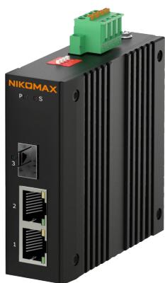
Медиаконвертер PoE промышл. неуправляемый NIKOMAX, UTP 2\*10/100/1000 Мбит/с (802.3af/at) до 250 метров, SFP 100/1000 Мбит/с, без LFP, PoE watchdog, Port isolation, 44-57В (без блока питания), -40 до +75
