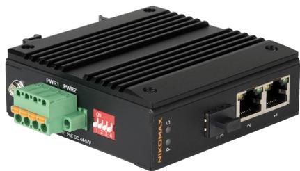
Медиаконвертер PoE промышл. неуправляемый NIKOMAX, UTP 2\*10/100/1000 Мбит/с (802.3af/at) до 250 метров, SFP 100/1000 Мбит/с, без LFP, PoE watchdog, Port isolation, 44-57В (без блока питания), -40 до +75
