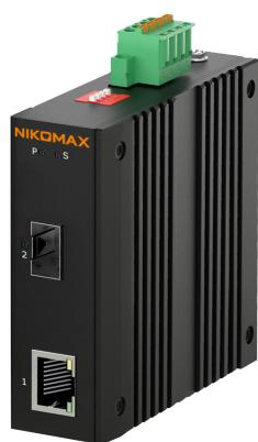
Медиаконвертер PoE промышл. неуправляемый NIKOMAX, UTP 10/100/1000 Мбит/с (802.3af/at) до 250 метров, SFP 100/1000 Мбит/с, LFP, PoE watchdog, 44-57В (без блока питания), -40 до +75
