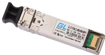
Оптический SFP+ модуль GL-OT-FCSRLC2-0850-0850-M-16G - продукт бренда NIKOMAX, предназначенный для подключения удаленного участка сети по многомодовому волокну без необходимости использования дополнительного усилителя.
