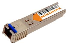
Модуль NIKOMAX SFP, 100/155 Мбит/с, WDM, 1 ОВ, SM, 1xSC, Tx:1550/Rx:1310 нм, DDM, 14 дБ (до 20 км)
