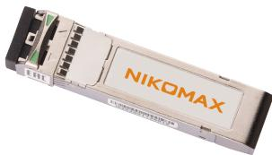
Модуль NIKOMAX SFP, 1.25 Гбит/с, Duplex, 2 ОВ, MM, 2xLC, Tx:850/Rx:850 нм, DDM, 7 дБ (до 550 м), -40 +85 °C
