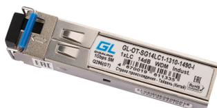
Модуль NIKOMAX SFP, 1,25 Гбит/с, WDM, 1 OB, SM, 1xLC, Tx:1310/Rx:1490 нм, DDM, 14 дБ (до 20 км), -40 +85 °С
