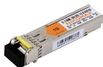
Модуль NIKOMAX SFP, 1.25 Гбит/с, WDM, 1 ОВ, SM, 1xLC, Tx:1550/Rx:1310 нм, DDM, 14 дБ (до 20 км)
