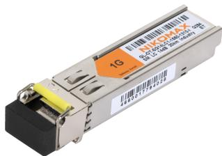
Модуль NIKOMAX SFP, 1.25 Гбит/с, WDM, 1 OB, SM, 1xLC, Tx:1550/Rx:1310 нм, DDM, 14 дБ (до 20 км), -40 +85 °С
