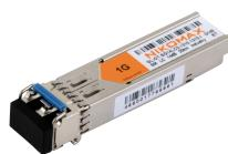
Модуль NIKOMAX SFP, 1.25 Гбит/с, Duplex, 2 ОВ, SM, 2xLC, Tx:1310/Rx:1310 нм, DDM, 14 дБ (до 20 км), -40 +85 °C
