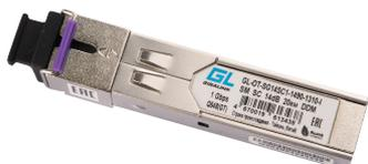
Модуль NIKOMAX SFP, 1.25 Гбит/с, WDM, 1 OB, SM, 1xSC, Tx:1490/Rx:1310 нм, DDM, 14 дБ (до 20 км), -40 +85 °С
