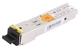
Модуль NIKOMAX SFP, 1.25 Гбит/с, WDM, 1 ОВ, SM, 1xSC, Tx:1550/Rx:1310 нм, DDM, 14 дБ (до 20 км), -40 +85 °C
