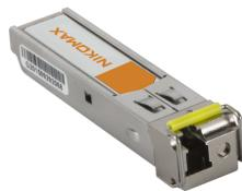
Модуль NIKOMAX SFP, 1.25 Гбит/с, WDM, 1 ОВ, SM, 1xLC, Tx:1310/Rx:1490 нм, DDM, 20 дБ (до 40 км)
