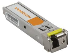
Модуль NIKOMAX SFP, 1.25 Гбит/с, WDM, 1 ОВ, SM, 1xLC, Tx:1490/Rx:1310 нм, DDM, 20 дБ (до 40 км)
