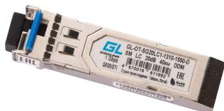
Модуль NIKOMAX SFP, 1.25 Гбит/с, WDM, 1 ОВ, SM, 1xLC, Tx:1550/Rx:1310 нм, DDM, 20 дБ (до 40 км)
