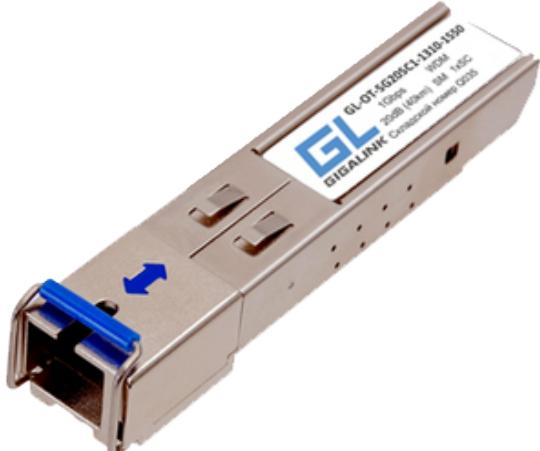
Модуль NIKOMAX SFP, 1.25 Гбит/с, WDM, 1 OB, SM, 1xSC, Tx:1310/Rx:1550 нм, DDM, 20 дБ (до 40 км), -40 +85 °C
