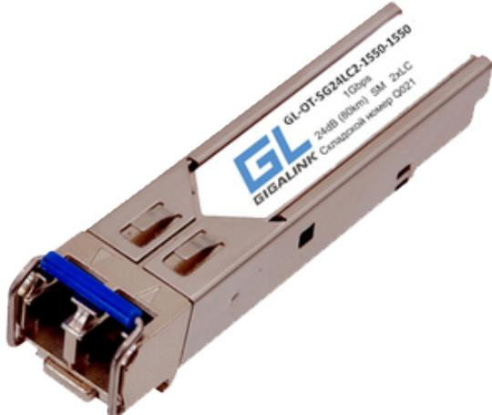
Модуль NIKOMAX SFP, 1.25 Гбит/с, Duplex, 2 OB, SM, 2xLC, Tx:1550/Rx:1550 нм, DDM, 24 дБ (до 80 км), -40 +85 °C
