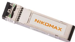
Модуль NIKOMAX SFP, 1.25 Гбит/с, Duplex, 2 OB, SM, 2xLC, Tx:1550/Rx:1550 нм, DDM, 24 дБ (до 80 км), -40 +85 °С
