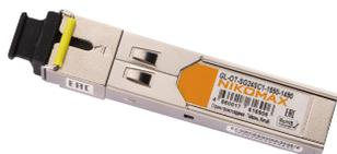
Оптический SFP модуль GL-OT-SG24SC1-1550-1490 - продукт бренда NIKOMAX, предназначенный для подключения удаленного участка сети по одномодовому волокну без необходимости использования дополнительного усилителя.
