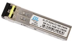
CWDM SFP модуль - это компактный сменный трансивер для организации передачи данных в сетях CWDM по протоколам Gigabit Ethernet, 1×Fibre Channel. CWDM SFP модуль GL-OT-SG34LC2-XXXX-CWDM - скорость передачи данных 1 Гбит/с, разъем LC, рабочая длина волны в диапазоне 1450-1610 нм с шагом 20 нм, дальность передачи до 120 км по одномодовому волокну, оптический бюджет 34 дБ. В передатчике используется лазер класса 1 согласно международному стандарту безопасности IEC-60825.
