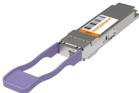
QSFP28 (Quad Small Form-factor Pluggable; SFF-8665) — промышленный стандарт модульных компактных сетевых трансиверов, применяющихся в высокоскоростных сетях передачи данных. QSFP поддерживается множеством производителей и позволяет использовать скорости передачи данных до 100 Гбит/с (4 канала по 25 Гбит/с каждый).
