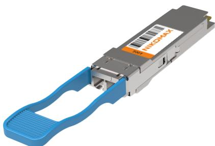
Модуль NIKOMAX GL-OT-SQ100LC2-DR1 предназначен для оптической линии связи до 500 м. Он предназначен для использования одномодового волокна в высокоскоростной передаче данных 100 Гбит/с. Оптические сигналы мультиплексируются в одномодовое волокно через стандартный разъем LC.
