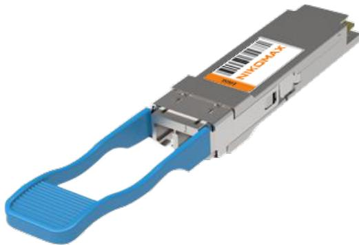
Модуль NIKOMAX GL-OT-SQ100LC2-LR4 предназначен для оптической линии связи на расстоянии до 10 км. Этот модуль содержит 4-полосный оптический передатчик, 4-полосный оптический приемник и блок управления модулем, включающий 2-проводной последовательный интерфейс. Оптические сигналы мультиплексируются в одномодовое волокно через стандартный разъем LC.
