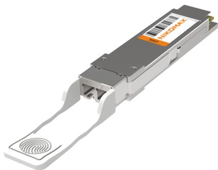
QSFP28 (Quad Small Form-factor Pluggable; SFF-8665) — промышленный стандарт модульных компактных сетевых трансиверов, применяющихся в высокоскоростных сетях передачи данных. QSFP поддерживается множеством производителей и позволяет использовать скорости передачи данных до 100 Гбит/с (4 канала по 25 Гбит/с каждый).
