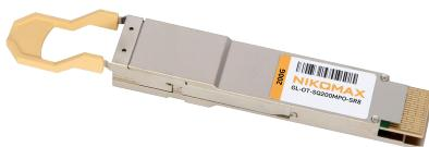
QSFP28-DD (Quad Small Form-factor Pluggable Double Density) — промышленный стандарт модульных компактных сетевых трансиверов, применяющихся в высокоскоростных сетях передачи данных. GL-OT-SQ200MPO-SR8 поддерживается множеством производителей и позволяет использовать скорости передачи данных до 200 Гбит/с (8 каналов по 25 Гбит/с каждый).
