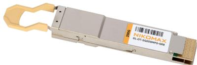
QSFP28-DD (Quad Small Form-factor Pluggable Double Density) — промышленный стандарт модульных компактных сетевых трансиверов, применяющихся в высокоскоростных сетях передачи данных. GL-OTSQ200MPO-SR8 поддерживается множеством производителей и позволяет использовать скорости передачи данных до 200 Гбит/с (8 каналов по 25 Гбит/с каждый).
