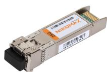
Модуль NIKOMAX SFP28, 25 Гбит/с, Duplex, 2 ОВ, MM, 2xLC, Tx:850/Rx:850 нм, DDM, 1.95 дБ (до 300 м)
