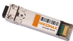
Модуль NIKOMAX SFP28, 25 Гбит/с, WDM, 1 ОВ, SM, 1xLC, Tx:1330/Rx:1270 нм, DDM, 6.3 дБ (до 20 км)
