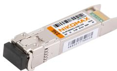
Модуль NIKOMAX SFP28, 25 Гбит/с, WDM, 1 ОВ, SM, 1xLC, Tx:1330/Rx:1270 нм, DDM, 6.3 дБ (до 20 км)
