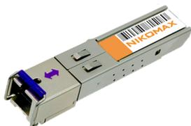
Модуль NIKOMAX SFP, 2,5 Гбит/с, WDM, 1 OB, SM, 1xSC, Tx:1310/Rx:1550 нм, DDM, 13 дБ (до 20 км)
