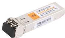
Оптический SFP+ модуль GL-OT-ST05LC2-0850-0850-M - продукт бренда NIKOMAX, предназначенный для подключения удаленного участка сети по многомодовому волокну без необходимости использования дополнительного усилителя.
