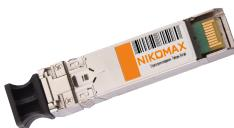
Модуль NIKOMAX SFP+, 10 Гбит/с, WDM, 1 ОВ, SM, 1xLC, Tx:1330/Rx:1270 нм, DDM, 8 дБ (до 10 км), -40 +85 °C
