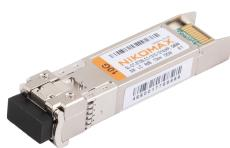
Модуль NIKOMAX SFP+, 10 Гбит/с, Duplex, 2 ОВ, SM, 2xLC, Tx:1310/Rx:1310 нм, DDM, 8 дБ (до 10 км), HP
