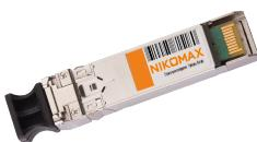
Модуль NIKOMAX SFP+, 10 Гбит/с, Duplex, 2 ОВ, SM, 2xLC, Tx:1310/Rx:1310 нм, DDM, 8 дБ (до 10 км), от -40 до +85
