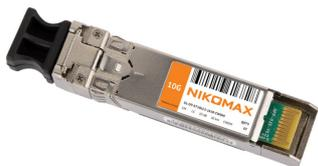
CWDM SFP+ модуль - это компактный сменный трансивер для организации передачи данных в сетях CWDM по протоколам 10 Gigabit Ethernet, SDH STM-64 / SONET OC-192. CWDM SFP+ модуль GL-OT-ST10LC2-XXXX-CWDM - скорость передачи данных 10 Гбит/с, разъем LC, рабочая длина волны в диапазоне 1270-1610 нм с шагом 20 нм, дальность передачи до 10 км по одномодовому волокну, оптический бюджет 10 дБ. В передатчике используется лазер класса 1 согласно международному стандарту безопасности IEC- 60825.
