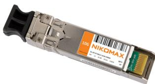
CWDM SFP+ модуль - это компактный сменный трансивер для организации передачи данных в сетях CWDM по протоколам 10 Gigabit Ethernet, SDH STM-64 / SONET OC-192. CWDM SFP+ модуль GL-OT-ST10LC2-XXXX-CWDM - скорость передачи данных 10 Гбит/с, разъем LC, рабочая длина волны в диапазоне 1270-1610 нм с шагом 20 нм, дальность передачи до 10 км по одномодовому волокну, оптический бюджет 10 дБ. В передатчике используется лазер класса 1 согласно международному стандарту безопасности IEC- 60825.
