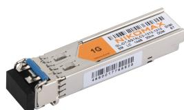
Модуль NIKOMAX SFP+, 10 Гбит/с, Duplex, 2 ОВ, SM, 2xLC, Tx:1310/Rx:1310 нм, DDM, 14 дБ (до 40 км)
