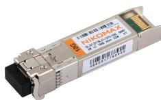
Модуль NIKOMAX SFP+, 10 Гбит/с, WDM, 1 ОВ, SM, 1xLC, Tx:1270/Rx:1330 нм, DDM, 16 дБ (до 40 км)
