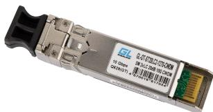
CWDM SFP+ модуль - это компактный сменный трансивер для организации передачи данных в сетях CWDM по протоколам 10 Gigabit Ethernet, SDH STM-64 / SONET OC-192. CWDM SFP+ модуль GL-OT-ST20LC2-XXXX-CWDM - скорость передачи данных 10 Гбит/с, разъем LC, рабочая длина волны в диапазоне 1270-1330 нм с шагом 20 нм, дальность передачи до 40 км по одномодовому волокну, оптический бюджет 20 дБ. В передатчике используется лазер класса 1 согласно международному стандарту безопасности IEC- 60825.
