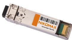
Модуль NIKOMAX SFP+, 10 Гбит/с, WDM, 1 ОВ, SM, 1xLC, Tx:1270/Rx:1330 нм, DDM, 21 дБ (до 60 км)
