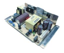
Блок питания для коммутатора NIKOMAX GL-SW-X201-12ST AC 220V
