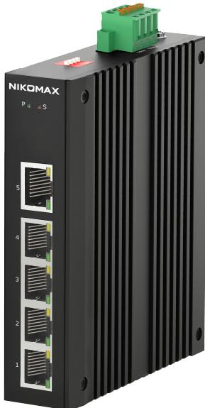
Неуправляемый промышленный коммутатор NIKOMAX Essential Line, 5\*10/100/1000Мбит/с Base-T, Крепление на DIN-рейку, 2\*ввода питания, питание 12-58В (блок питания поставляется отдельно), -40С +75С
