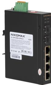
Неуправляемый промышленный коммутатор NIKOMAX, 4\*10/100/1000Мбит/с PoE (af/at), 2\*1Гбит/с SFP, DIN rail, 2\*ввода питания, питание 44-57В (блок питания 120Вт поставляется отдельно), -40С +75С.
