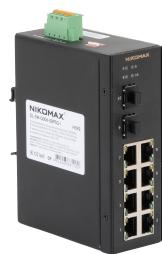
Неуправляемый промышленный коммутатор NIKOMAX, 8\*10/100/1000Мбит/с PoE (af/at), 2\*1Гбит/с SFP, DIN rail, 2\*ввода питания, питание 44-57В (блок питания 240Вт поставляется отдельно), -40С +75С.
