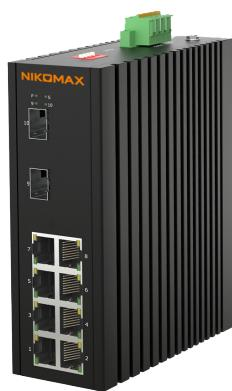
Неуправляемый промышленный коммутатор NIKOMAX, 8\*10/100/1000Мбит/с PoE (af/at/BT) из которых 4 порта PoE BT, 2\*1Гбит/с SFP, DIN rail, 2\*ввода питания, питание 44-57В (блок питания 240Вт поставляется отдельно), -40С +75С.
