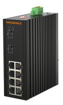
Неуправляемый промышленный коммутатор NIKOMAX, 8\*10/100/1000Мбит/с РоЕ (af/at/BT) из которых 4 порта РоЕ BT, 2\*1Гбит/с SFP, DIN rail, 2\*ввода питания, питание 44-57В (блок питания 240Вт поставляется отдельно), -40С +75С.
