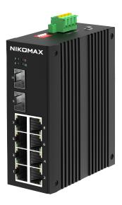
Неуправляемый промышленный коммутатор NIKOMAX Essential Line. 8\*10/100/1000Мбит/с Base-T, 2\*1Гбит/с SFP, Крепление на DIN-рейку, 2\*ввода питания, питание 12-58В (блок питания поставляется отдельно), -40С +75С
