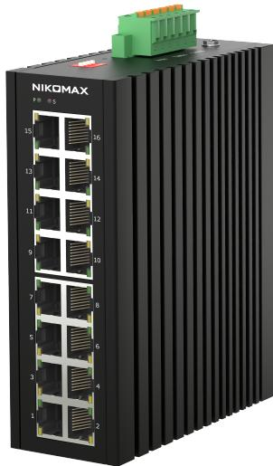
Неуправляемый промышленный коммутатор NIKOMAX Essential Line, 16\*10/100/1000Мбит/с Base-T, Крепление на DIN-рейку, 2\*ввода питания, питание 12-58В (блок питания поставляется отдельно), -40С +75С
