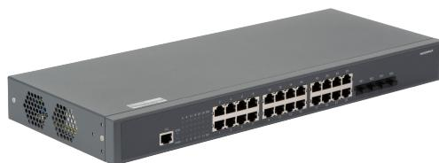
Управляемый коммутатор NIKOMAX, L2++ Stack, 24\*10/100/1000Мб/с BASE-T, 4\*1/10 Гбит/с SFP+, 1 RJ45 консольный порт, 1U 19", 220В
